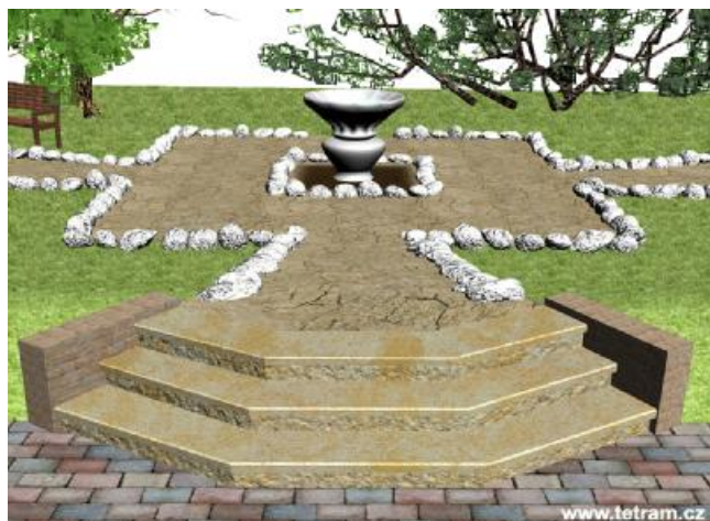
Schody je možné kromě klasické rovné varianty sestavit i do širokého schodiště seříznutím a sesazením stupnic a podstupnic (viz ukázky nahoře a dole). Schody mají na obou vyobrazeních tesané podstupnice. (model)
