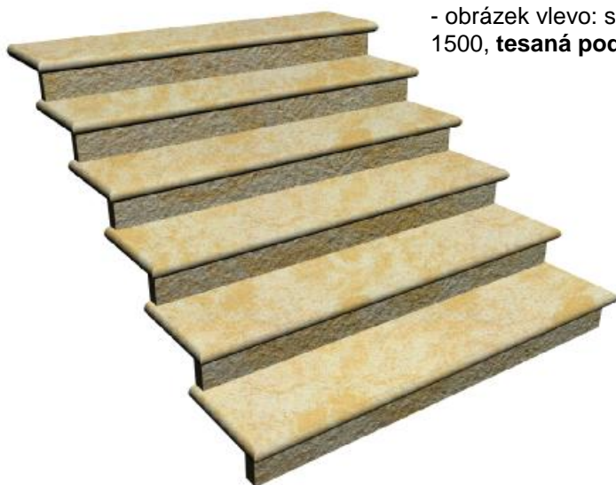
stupnice S2 má přední stranu vždy zaoblenou (model)
