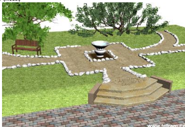
Schody je možné kromě klasické rovné varianty sestavit i do širokého schodiště seříznutím a sesazením stupnic a podstupnic (viz ukázky nahoře a dole). Schody mají na obou vyobrazeních tesané podstupnice. (model)
